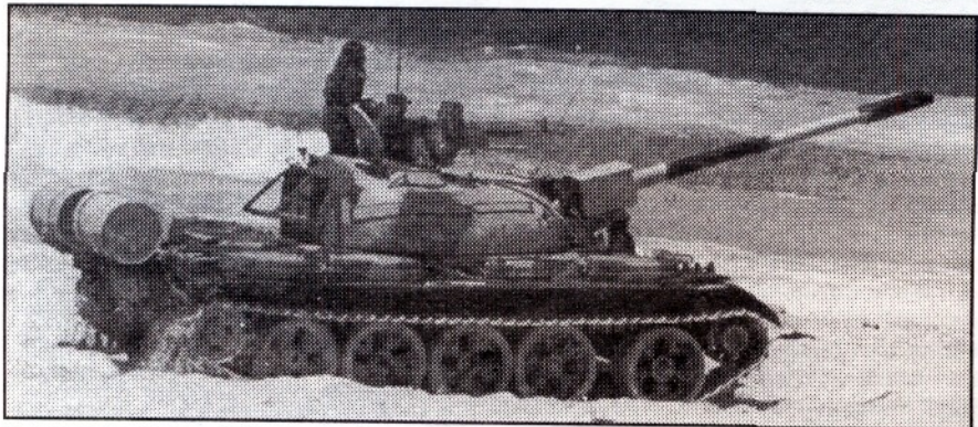
■ Египетский танк Т-55 с контейнером ИК-системы ночного видения от танка «Леопард-1»
