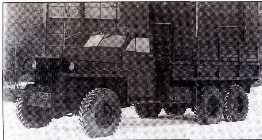
■ Экспериментальный автомобиль «Студебекер» US6-62 с односкатными шинами, 1944 года
