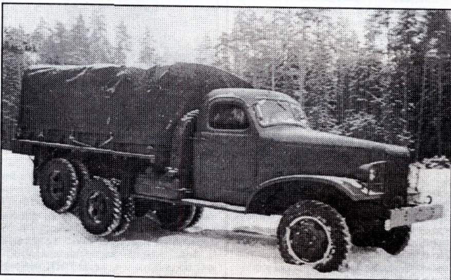
■ Первый опытный образец автомобиля ЗИС-151-2 на испытаниях зимой 1946—1947 гг.
